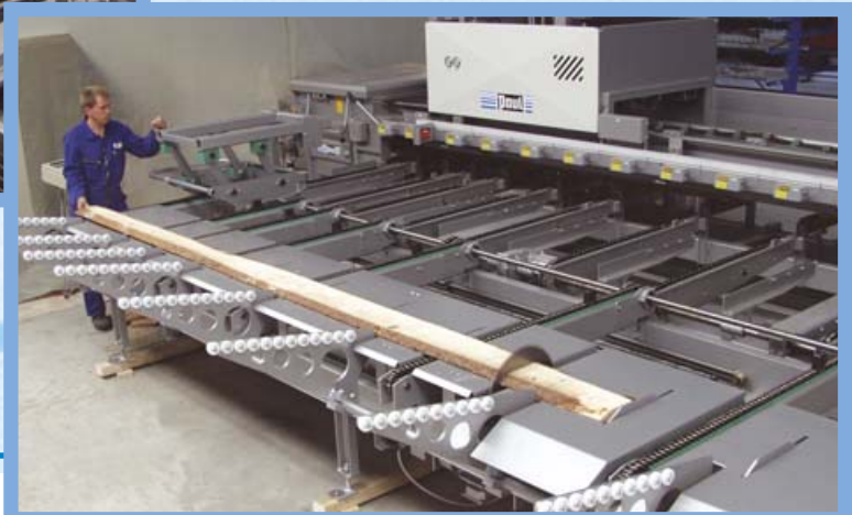
Abb. 6: AB 920 mit Durchlaufkappsäge
