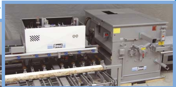
Abb. 4: AB 920 kombiniert mit einer Gleichlaufkreissäge S 1500 GL
