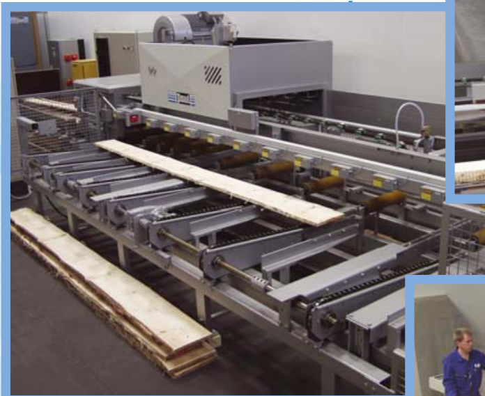
Abb. 5: AB 920 mit Besäumsäge BK 1000
