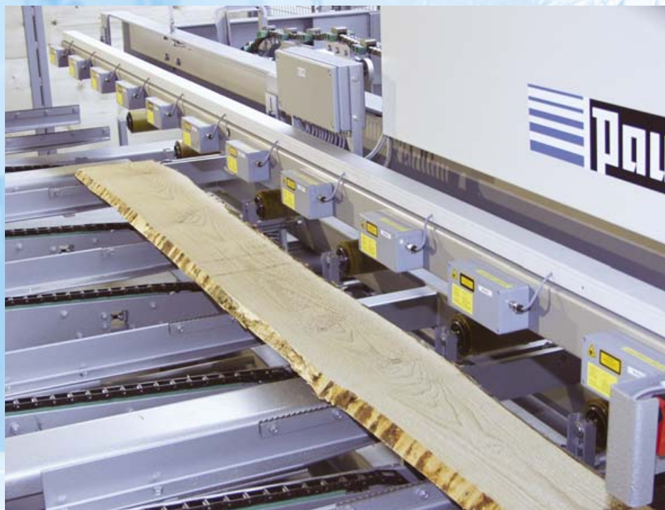
Abb. 2: AB 920 mit berührungsloser Vermessung durch Triangulationsköpfe
