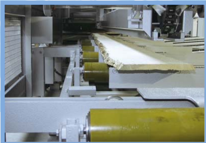
Abb. 14: Drehen des Brettes für optimale Ausrichtung
