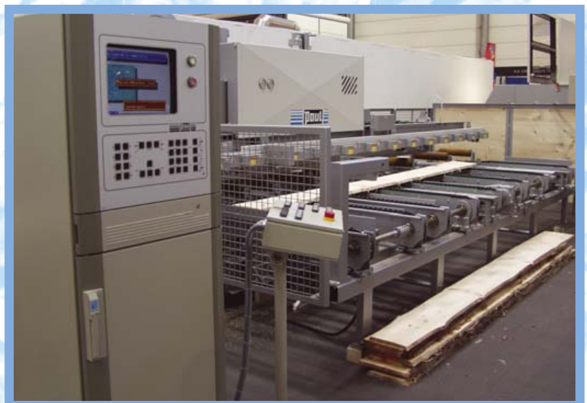
Abb. 16: Staubdichtes Bedienungsterminal mit 14 Zoll VGA-Farbmonitor
