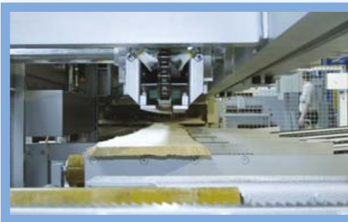
Abb. 9: Optimales Ausrichten durch schwenkbaren Ausrichttisch
