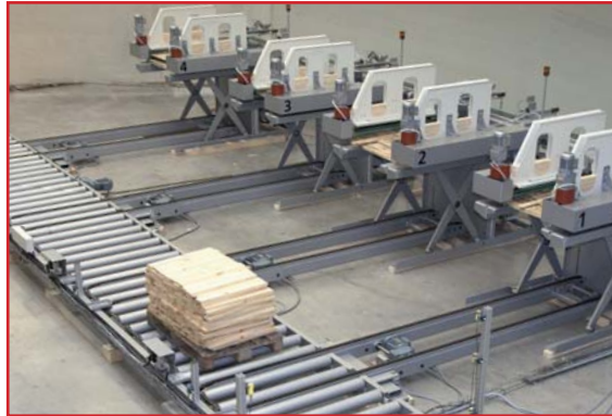
Abb. 13: Stapelanlage aus vier Stapelautomaten und einer angetriebenen Rollenbahn für den Abtransport der fertigen Ware
