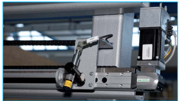
Abb. 12: Linienlaser zeigen die Positionen der Sägeblätter
