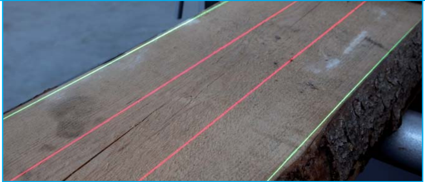
Abb. 16: Linienlaser zur leichteren Ausrichtung der Werkstücke
