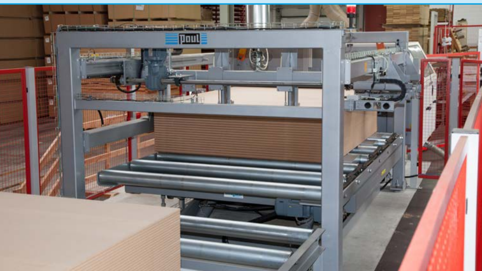
Fig. 27: Scie multilames équipée d'un système d'alimentation automatique dans la production de bandes
