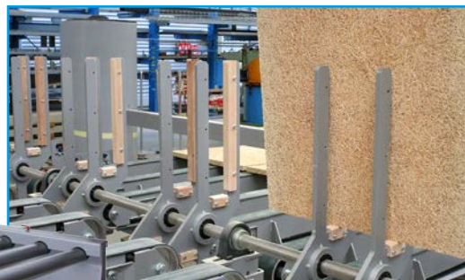
Fig. 23: Dispositif automatique de retournement des panneaux
