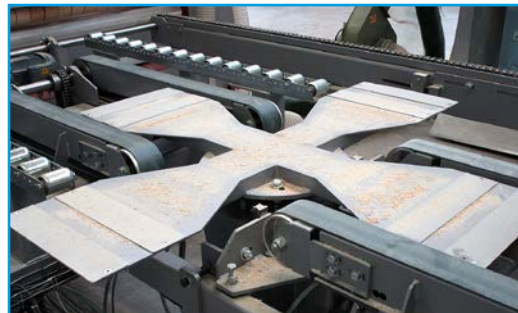
Fig. 21: Dispositif automatique tournant les panneaux
