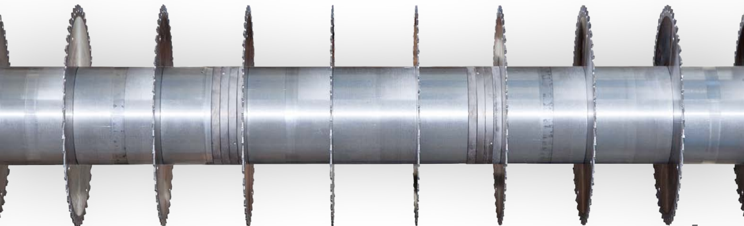
Fig. 12: Arbre de scie équipé d'outils et d'entretoises
