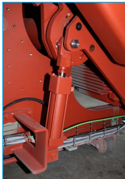
Fig. 6: Réglage de la hauteur de l'arbre de scie moyennant un vérin hydraulique
