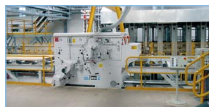
Abb. 3 Modell SK-OU/1500 bei der Produktion von LVL-Streifen
