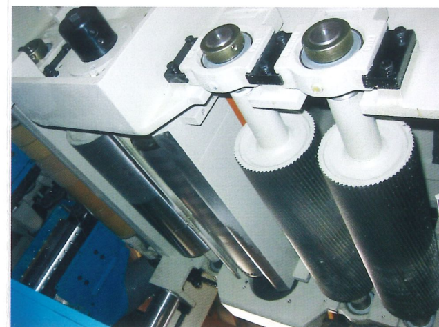
Rouleaux d'entraînement supérieurs et raboteur
