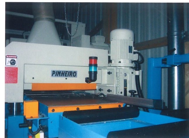
Dispositif bois toutes largeurs avec fraise référençieuse version moulurière
