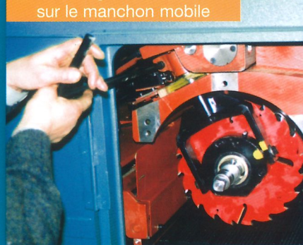
Montage de la lame sur le manchon mobile
