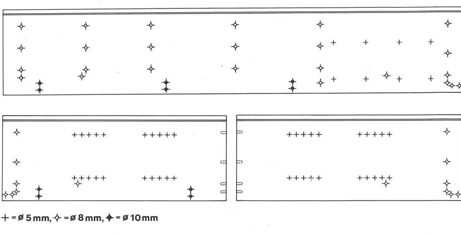
Die Eingabe der Bohrbilder erfolgt an der Maschine direkt von einer Zeichnung oder einem Musterteil. Diese Aufgabe erfordert keine speziellen Programmierkenntnisse, da die Steuerung mit einer Bedienerführung und übersichtlichen Eingabelisten ausgerüstet ist.
