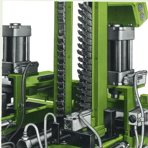
Machine automatique à percer et à insérer modèle BAT-X pour charnières à pot, plaques de montage, ferrures de jonction et autres.
