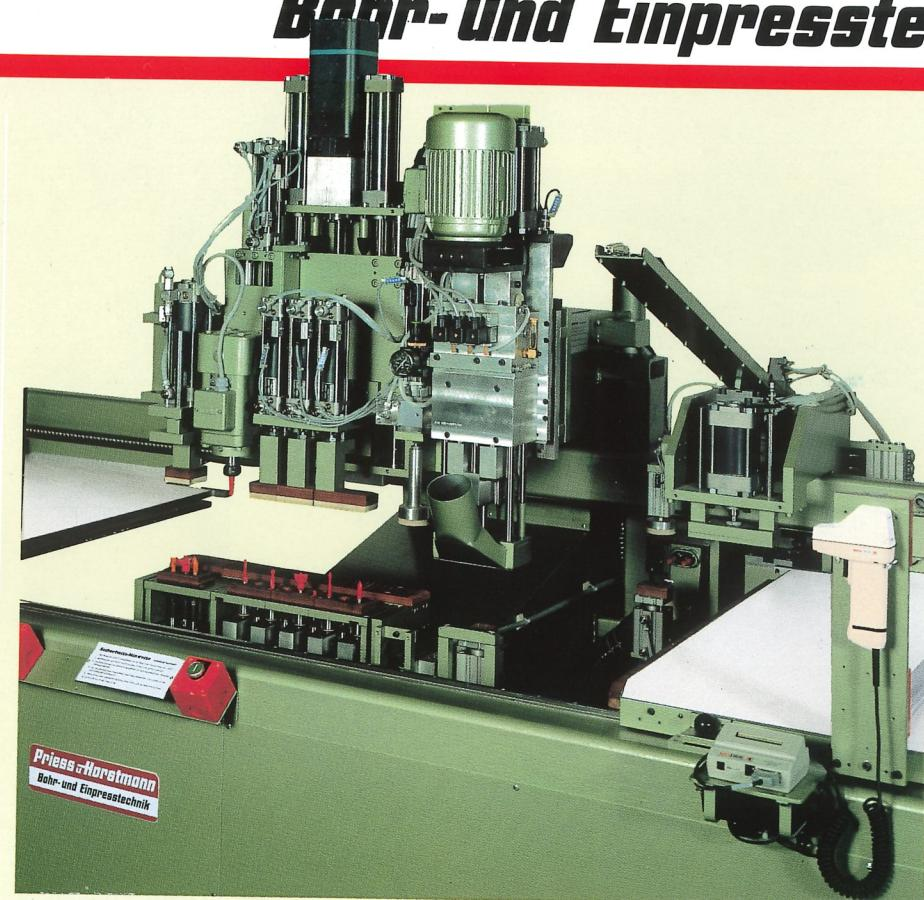
Die Detailaufnahme zeigt einen Support mit Aggregaten die ein Bearbeiten des Werkstückes von oben, unten und stirnseitig ermöglichen. Ferner ist ein BAR-CODE Scanner zum Einlesen der Programme abgebildet sowie ein nach vorn gebogenes Magazin zum Nachlegen der Scharniere von der Bedienerseite.
