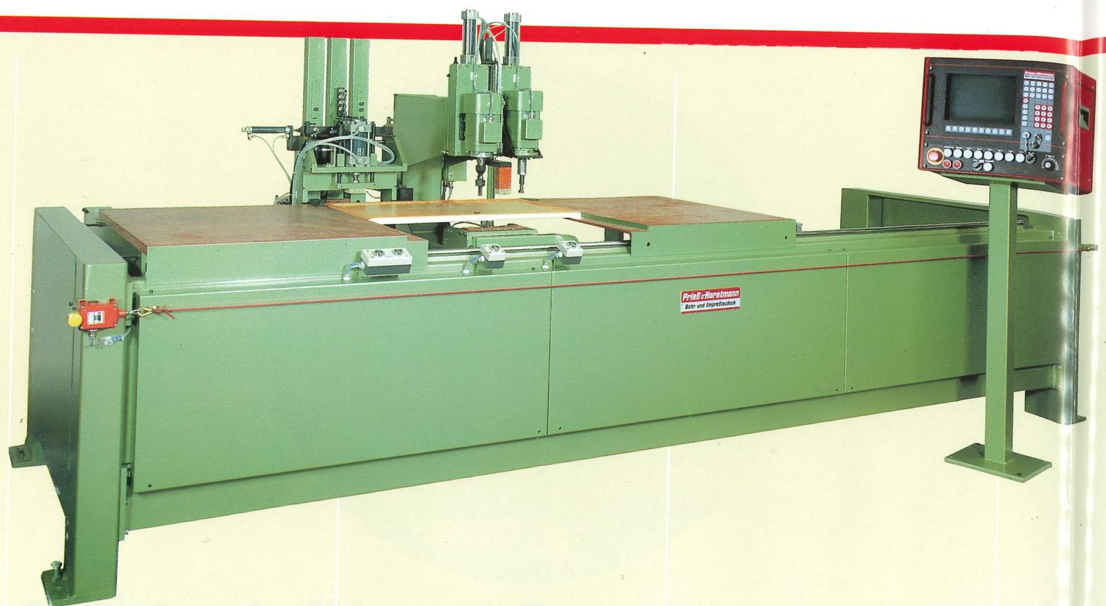
**Bohr- und Einpreßautomat BAT-III-CNC für Topfscharniere, Türpuffer, Adapter und Schlosser mit Einplatzbearbeitung oder mit Zweiplatzbearbeitung**
