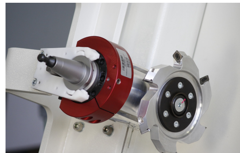
Cambio automatico mandrino / Changement automatique du mandrin
