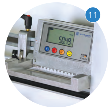
Lettore digitale quote verticali Affichage Digitale Coupes Verticales
