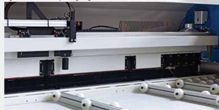
Accostatore automatico posteriore su guida con pattini a ricircolo di sfere. Automatically controlled rear aligner on rail with recirculating ball bearings. Alineador trasero automático sobre guía con recirculación de bolas. Automatischer hinterer Ausrichter auf Führungen mit Kugelzirkulations-Gleitblöcken Aligner arrière automatique sur guidage à recirculation de billes.
