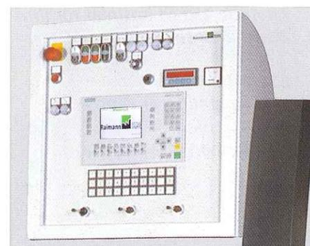
**"Mastercut 1-3":** Für computerunterstütztes Sägen bei Blattverstellmaschinen. Absolutmaße oder hinterlegte Fixmaße können gezielt nach Bedarf abgearbeitet werden.
