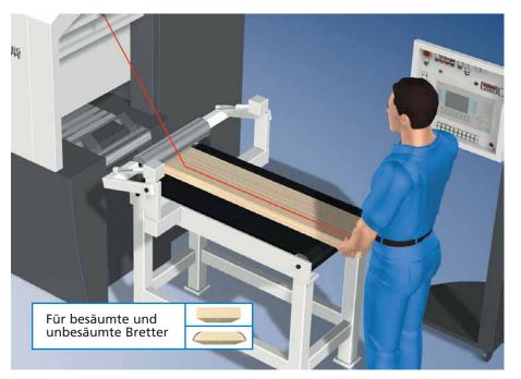
Bretter werden auf dem Transportband vom Bediener an der Null-Linie ausgerichtet; mit dem verstellbaren Laser werden Brettbreite oder Qualitätszonen markiert. TimberMax errechnet die optimale Maßkombination und positioniert die verstellbaren Sägeblätter. Transportband und pneumatisch betätigte Oberdruckrolle führen die Bretter der Vielblattkreissäge zu.
