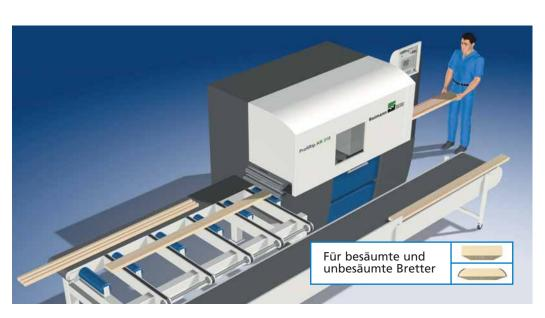
Die aufgetrennten Bretter werden hinter der Vielblattkreissäge auf ein Transportband übergeben. Querketten ziehen das Reststück nach links auf das Rücklaufband ab, wo es automatisch zum Bediener zurückgeführt wird. Die gesägten Leisten und Abfälle werden geradeaus weitertransportiert.
