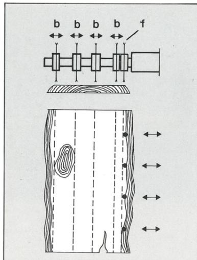
Die elektronische Vermessung der Brettbreite bei besäumten und unbesäumten Werkstücken ist ein wichtiger Baustein in unseren Optimierungssystemen. Die zur Verfügung stehende Brettbreite wird an unser Optimierungsprogramm Modell Optimatik übermittelt. Die Aufteilung und der Zuschnitt erfolgen nach vorgewählten Breiten des Endproduktes und Stückzahlen. Basierend auf dem jeweiligen Ist-Wert errechnet der Computer die optimale Position für die beweglichen Sägeblätter und Anschläge.
