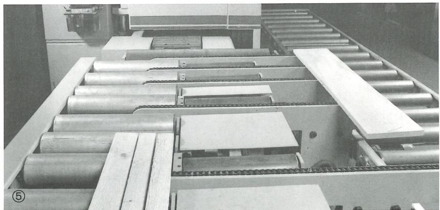
Der Auszugs- und Trennförderer, Modell Q2 (Abb. 2 und 3) trennt das fertige Schnittgut automatisch vom Reststück. Angetriebene Querketten fördern das Schnittgut nach rechts und das Reststück nach links. Das Gerät kann mit einer Verstellung der Trennlinie ausgerüstet werden. Die Verstellung kann manuell erfolgen (Abb. 4), oder aber mit Hilfe einer Elektronik synchron mit einem beweglichen Sägeblatt in der vorgeschalteten Maschine verfahren werden.
