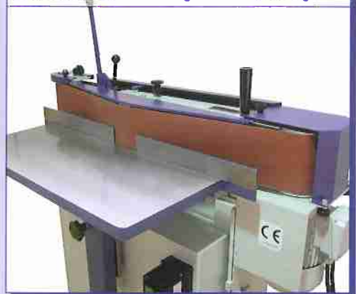
Kontaktschleifeinrichtung / veneer sanding unit
