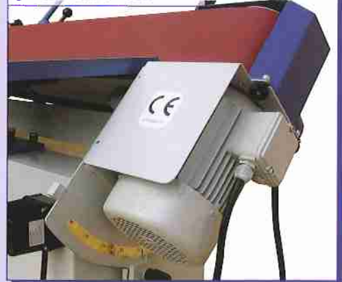
Kontaktschleifeinrichtung / veneer sanding unit
