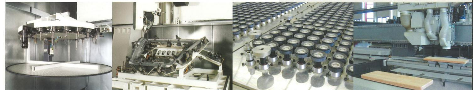
Für individuelle Anwendungsfälle gibt es angepasste Spannvorrichtungen und Aggregate. Ein 5-Achs-Bearbeitungsaggregat auf separat verfahrbaren Aggregateschlitten sowie bauteilspezifische Spannkomponenten zeigen Beispiele der Funktionsvielfalt. Je nach Kundenanforderung werden die Aggregate mit automatischen Werkzeugwechslern dem individuellen Bedarfsfall angepasst. Bei erhöhten Werkzeuganforderungen kann ein Werkzeugregal mit bis
