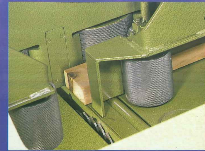
Sicht auf den ausgeleuchteten Schnittbereich – Ausschneiden eines Astes. Breitenunterschiede von max. 20 mm im selben Werkstück sind ohne Bedeutung. Sollen wechselnde Breiten verarbeitet werden, so ist eine auto. Breiteneinstellung erforderlich.
