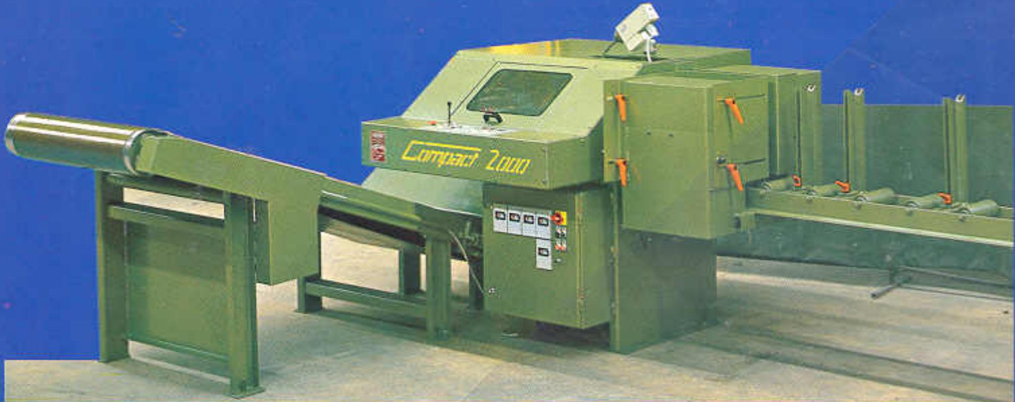
Compact 2000 mit Eintaftisch, Teilemagazin, Optik-Kopf und Bandförderer für den Abtransport der Abschnitte. Der Bediener markiert die Werkstücke dort an wo ein Sägeschnitt erfolgen soll und legt die Teile in das Magazin ein. Die Maschine arbeitet die Werkstücke sukzessive ab.
