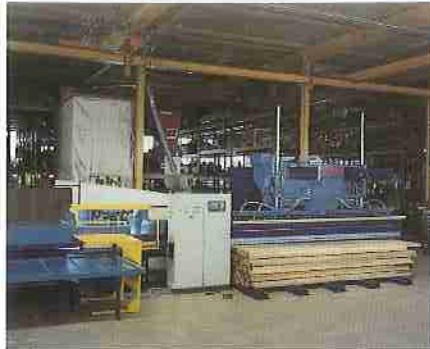
Vollautomatische Beschickung der Kappsäge durch einen Vakuum-Umsetzer
