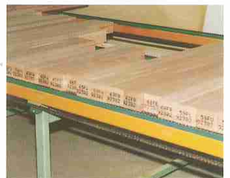
Automatische Beschriftung der Stirnseite mittels Tintenstrahldrucker
