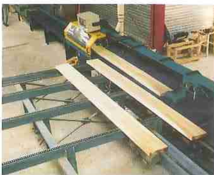
Vollautomatische Beschickung der Kappanlage über einen Kettenquerförderer
