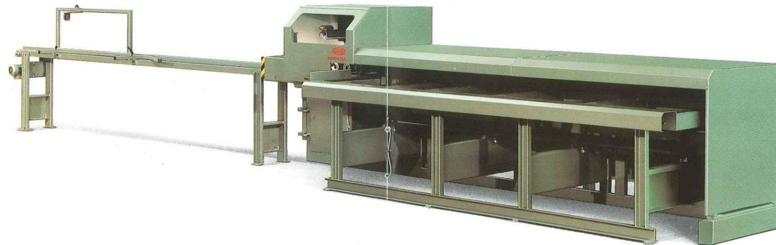
Das Werkstück wird auf den Querförderer aufgelegt und von einem Scanner vollautomatisch vermessen. Gleichzeitig dient der Querförderer als Zwischenpuffer, aus dem sich die Maschine automatisch das zu verarbeitende Werkstück holt.
