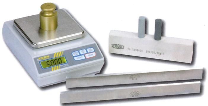
Die Messer in einem Kopf oder einer Welle sollten Gewichtsgleich geschliffen sein. Hierfür ist eine genaue Waage wichtig.
