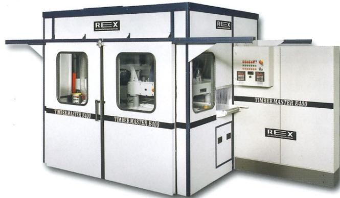
Die Timbermaster E 400 in der bedienerfreundlichen und voll zugängigen Schallschutz- und Sicherheitskabine. Die vorderen und hinteren Schiebetüren lassen sich über die gesamte Länge öffnen.
