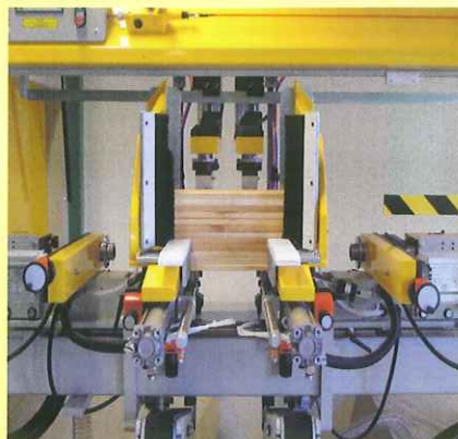
Durch die Bürsten wird das Holz leicht in die Maschine eingegeben.
