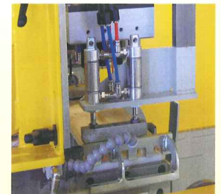
Die Kombination von pneumatisch geföhrt Werkstückspanner und Seitenspanner ergibt eine optimale Präzision.
