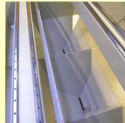
Die Maschine ist mit integrierter Spansaugung gebaut. Anschlussmöglichkeiten in beiden Enden der Maschine.
