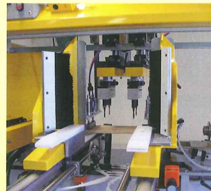
Das Holz wird pneumatisch gegen die Werkstückspanner geföhrt, und wird in diese Position festgehalten. Das einmalige Druckregulierungssystem sichert eine hohe Qualität ohne Druckschaden.
