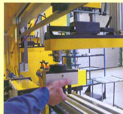
Die Bohrköpfe werden durch einen Quick-Schloss-System festgehalten. Die Bohrköpfe können frei, zwischen 0 und 90° gedreht werden.
