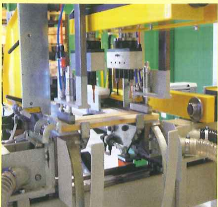
Die Werkstückspanner sind pneumatisch geföhrt, und passt sich automatisch die breite des Holzes an. Die Werkstücke sind immer, im Verhältnis zum Nul-Punkt, korrekt festgehalten.
