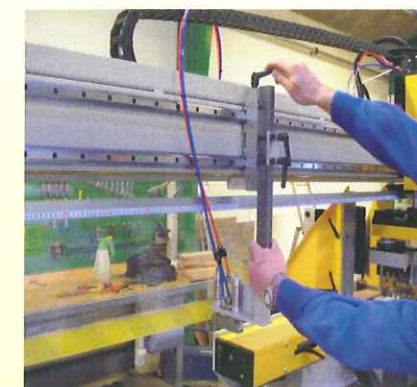
Die Werkstückspanner werden leicht mit einem Griff bedient, und sind leicht in Position zu bringen.
