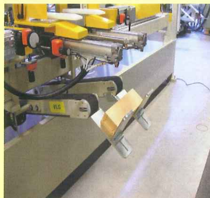
Die Werkstücke werden schonend zum Bediener zurückgeföhrt, das Förderband kann durch das Steuerungssystem beliebig programmiert werden.
