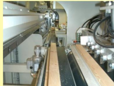
Die Teile werden vom Pufferband über das Einlaufband getaktet, welches die Werkstücke der Bearbeitungskabine zuführt.
