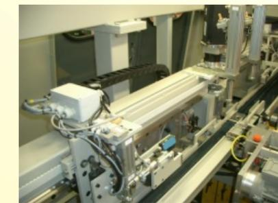
Zwei starke Servomotore sorgen für den sicheren Halt der Werkstücke und arbeiten in sehr hohem Tempo. Einige Bearbeitungseinheiten sind fest montiert, andere können verschoben werden.
