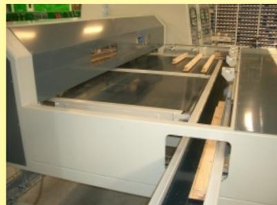
Einlauf mit Pufferband. Werkstücke kommen in der Regel von Hobel und Doppelendprofiler.
