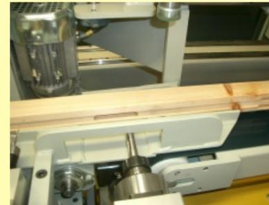
Langlochfräsen für Schlosseinsätze. Unter dem Werkzeug ist der Bohrkasten zu sehen, der die Grifflöcher bohrt.
