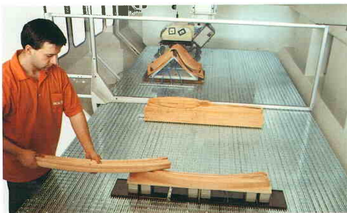
Paratia in polycarbonato per le lavorazioni a pendolo.
