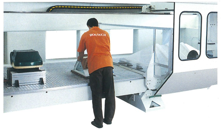
Polykarbonat-Trennwand für Bearbeitungen im Pendelverfahren.
