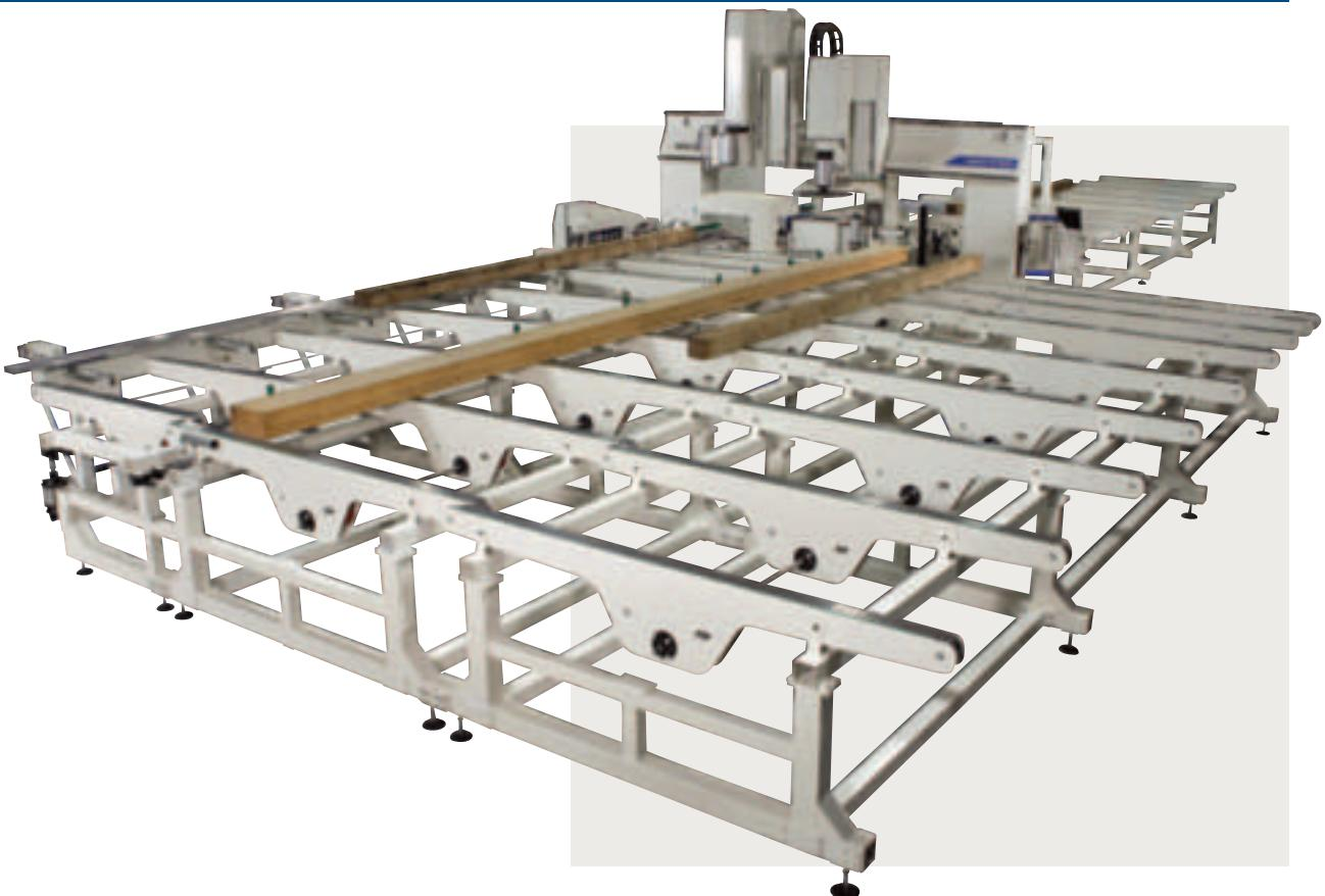
Ai sempre più elevati costi della manodopera e ritmi di produzione serrati, OIKOS RT4000 risponde con un sistema di alimentazione automatico che permette di caricare la macchina senza la presenza continua dell'operatore. Grazie ad un robusto sistema di trasporto, unito ad un singolarizzatore, è possibile caricare un intero lotto di travi che verranno alimentate in macchina in modo automatico senza rovinarne la superficie.
