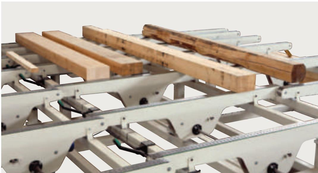
Per incontrare ogni esigenza produttiva OIKOS RT4000 riesce a bloccare sezioni fino a 800 x 300 mm e sezioni particolari quali "travi fiume" di dimensione 350 x 350 mm.
