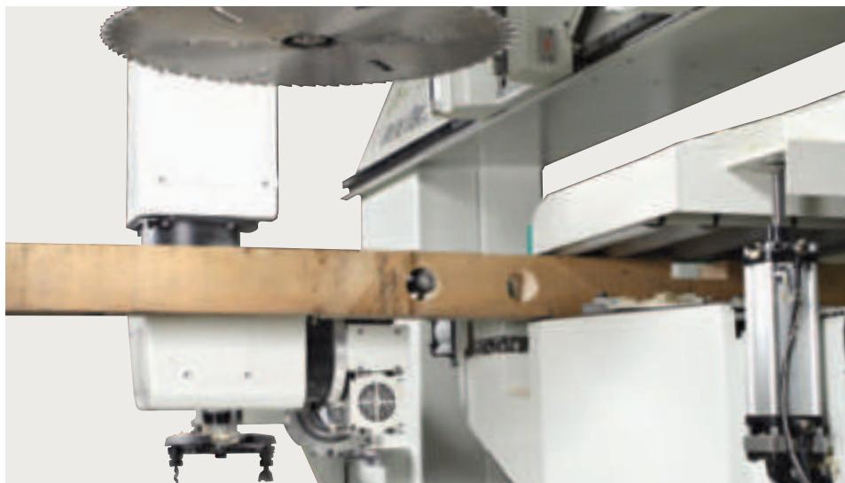
OIKOS RT4000, grâce à l'unité de fraisage indépendante à 5 axes, dépasse les limites traditionnelles dans l'usinage des poutres.
