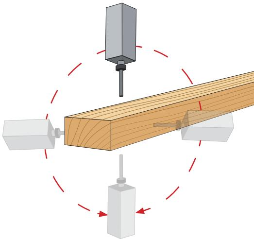
OIKOS RT4000 è una sfida a migliorare il processo di lavorazione della trave. Travi che presentano lavorazioni su tutte le facce possono essere lavorate in unico posizionamento, senza doverle girare. Ne deriva una maggiore velocità di esecuzione ed una precisione di lavorazione unica nel settore.
