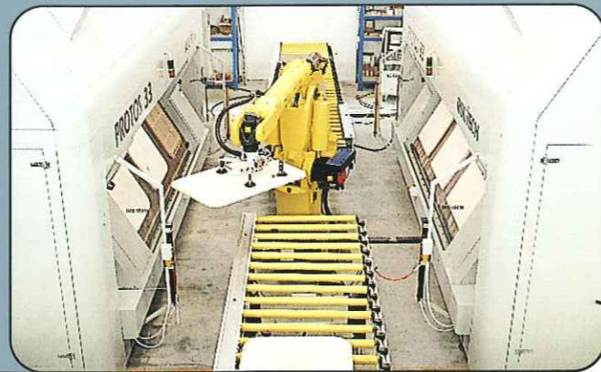
Protos mit Roboter für Beschickung und Entnahme der Teile
