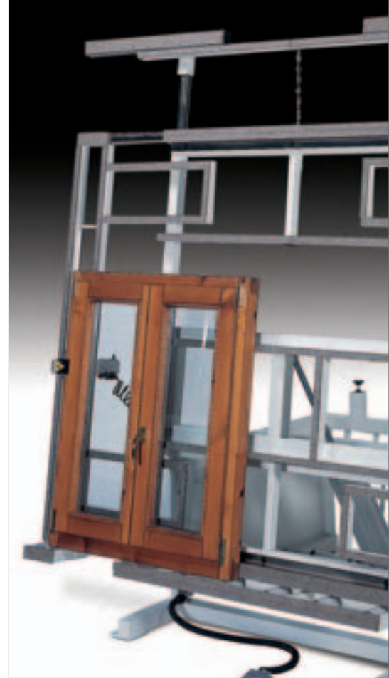
Banco in posizione verticale con un telaio e ante vetrate bloccato dal pistone sx
