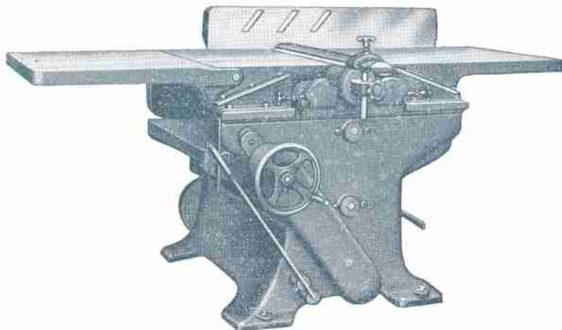
**Kombinierte Abricht-, Füge-, Kehl- und Dickenhobelmaschine** Typ: CHT 600
