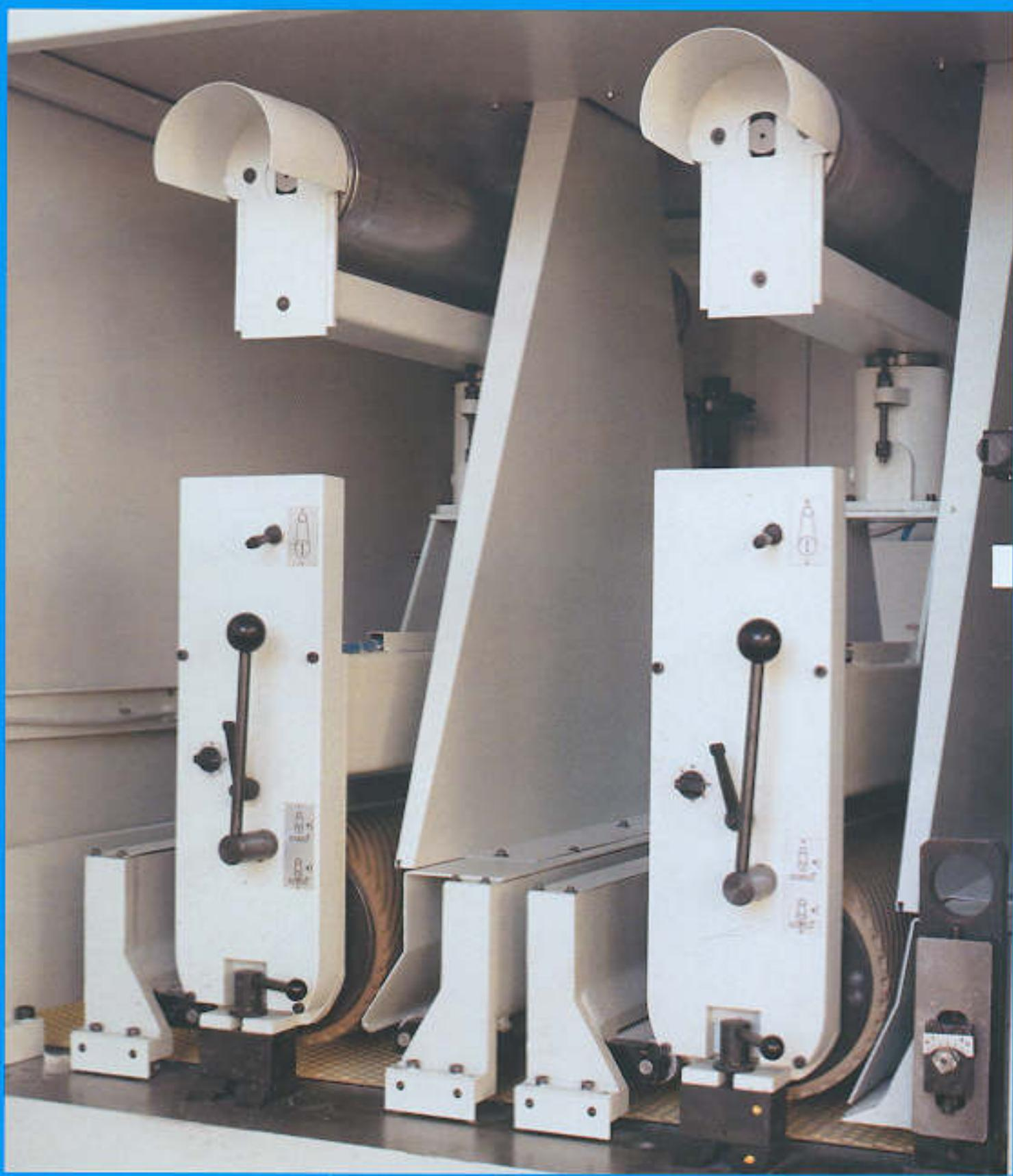
**2W/L****Esecuzione di macchina calibratrice levigatrice a due nastri.**
