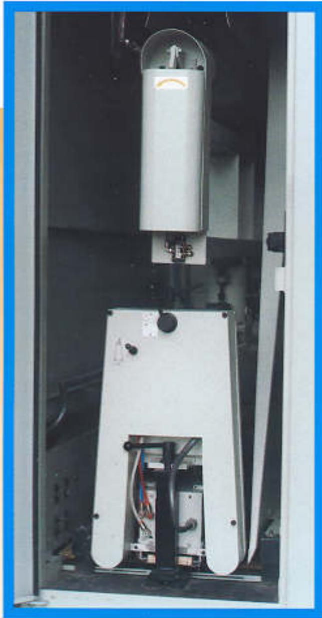
Rullo finitore Ø 400 mm gommato, con tastatori in acciaio a rulli incorporati per il comando dei pianetti sezionati
