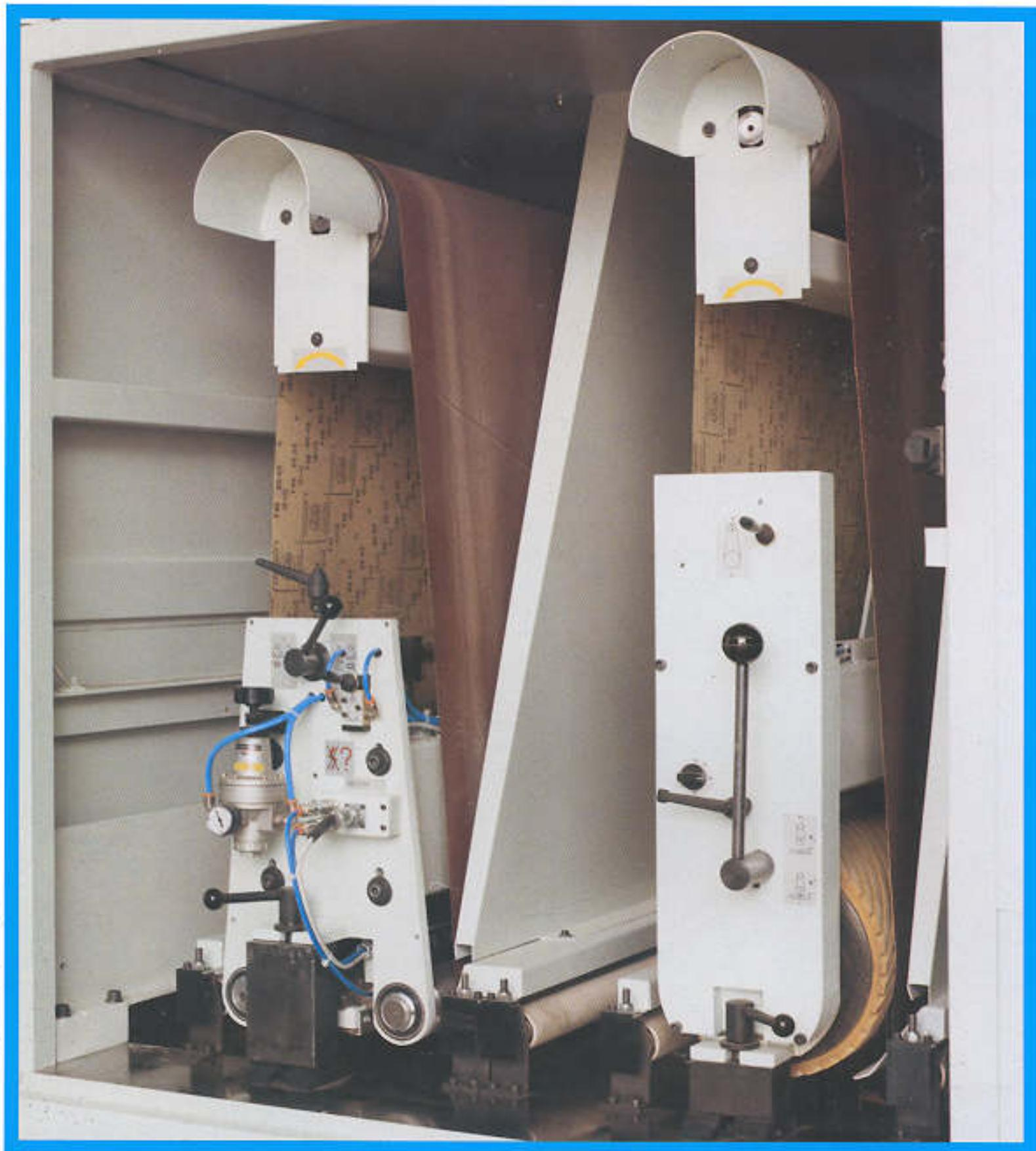
**WS****Esecuzione di macchina calibratrice levigatrice a due nastri.**
