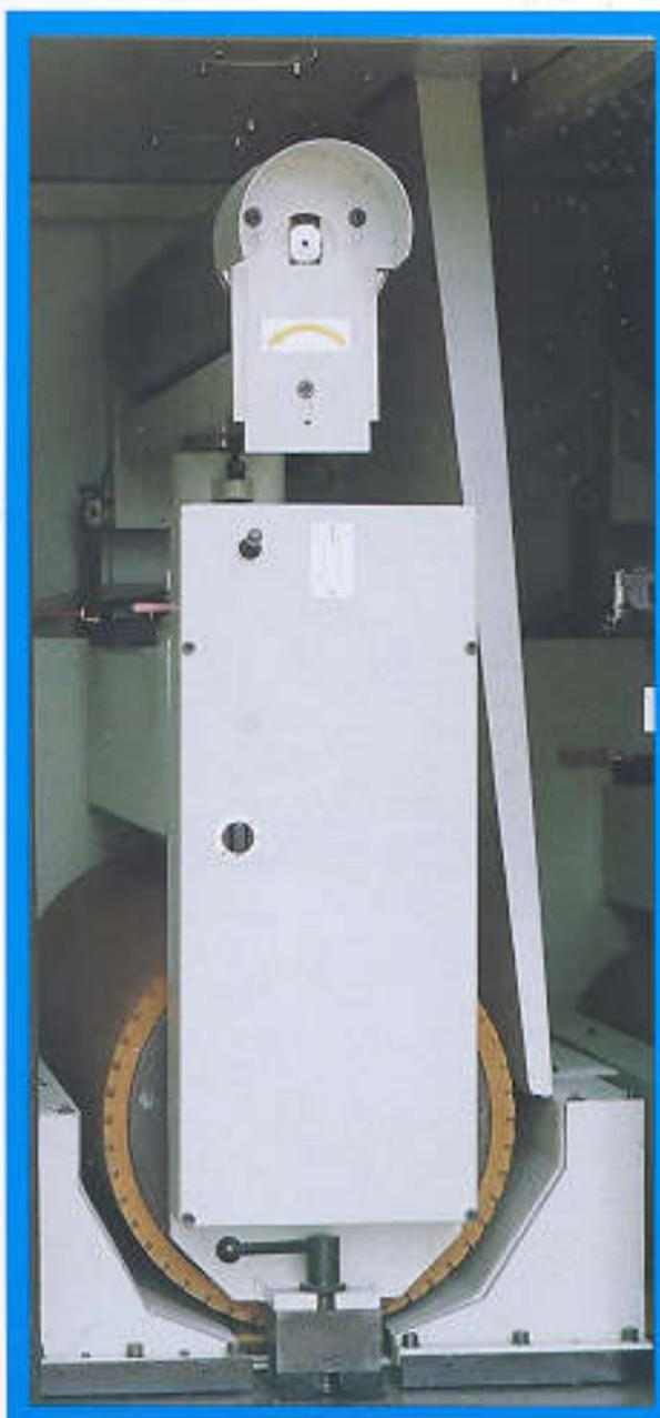
Rullo finitore Ø 400 mm gommato con fastatori a scarpa.
