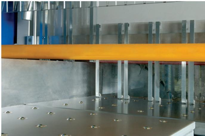
Geschlossenes Druckbalkensystem mit patentierter CLEAN-UP Funktion – 99,5 % Staub- und Spänefreiheit. **SAUBERKEIT PLUS+**
