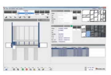
Anzeige des aktuellen Schnittplans, des Schnittes, des Auftrags und des Materials auf dem Bildschirm.
