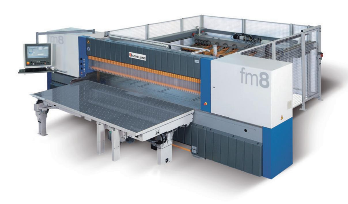
Die Bedienung noch leichter und die Bearbeitung noch produktiver macht der patentierte Drehtisch mit 90 Grad-Drehung. Schelling hat vor 30 Jahren den Drehtisch erfunden und seither kontinuierlich weiterentwickelt. Heute ist die komplette Maschine auf den Drehtisch angepasst. Er ist verfahrbar und halbautomatisch. Platten und Streifen werden mit ihm im Nu erst längs, dann quer aufgeteilt.
