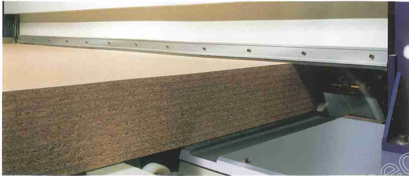
Hartverchromte Maschinentische (wahlweise) Hardchromed machine tables (optional) Tables de la machine chromées dur (en option)
