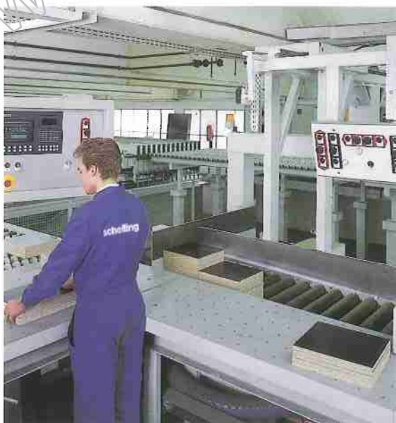
Handstapelgerät Manual stacking device Dispositif d'empilage manuel
