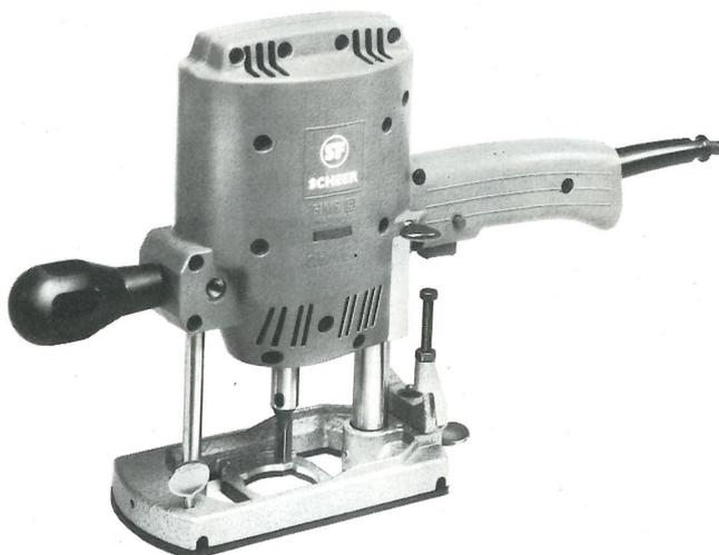
Handoberfräse HM 9, für leichte Fräsarbeiten mit Universalmotor für Gleich- und Wechselstrom, Leistung 1000 Watt bei nur 3.2 kg Nettogewicht, mit Mehrfachtiefenanschlag für 2 Frästiefen plus Durchgang, mit Außengewinde M 10 oder mit Spannzange (6 mm oder 1/4")
