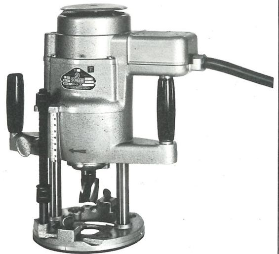
Handoberfräse HM 40 D, für schwerste Fräsarbeiten im Dauerbetrieb, vor allem für Treppenwangenfräsen, als Antriebsmaschine für das Tischfräsgesetz TF 2 geeignet, mit eingebautem Drehstrommotor, Leistung 1800 Watt, bei nur 11,8 kg Nettogewicht, mit geräuscharmem Spezialgetriebe und automatischer Schmierung. Eine äußerst robuste Konstruktion, die auch überlastet werden kann!
