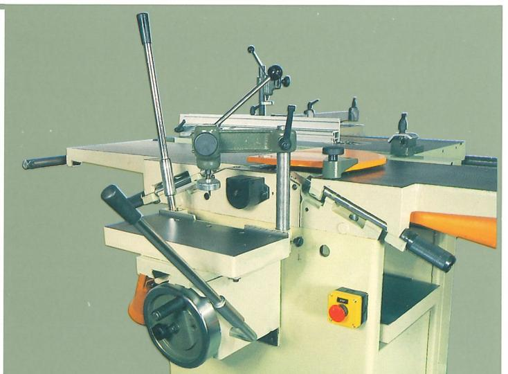
Il cambio della velocità meccanico sul gruppo toupie consente l'utilizzo della massima potenza del motore a tutte le tre velocità.
