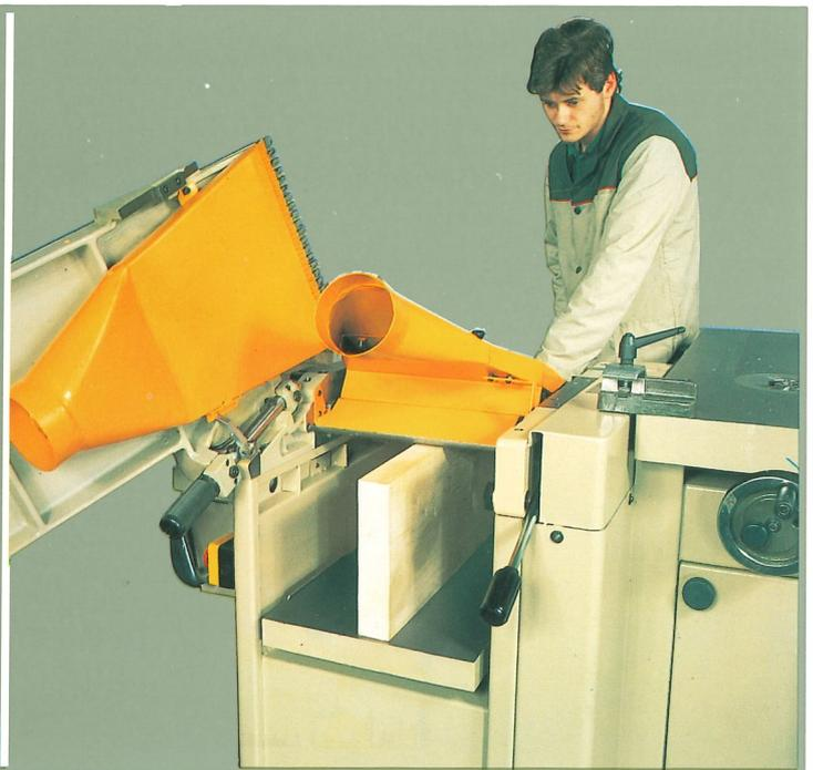
I piani nella funzione piallatura a filo sono stati dimensionati in modo da permettere la piallatura ed il raddrizzamento di pezzi anche di notevole lunghezza.
