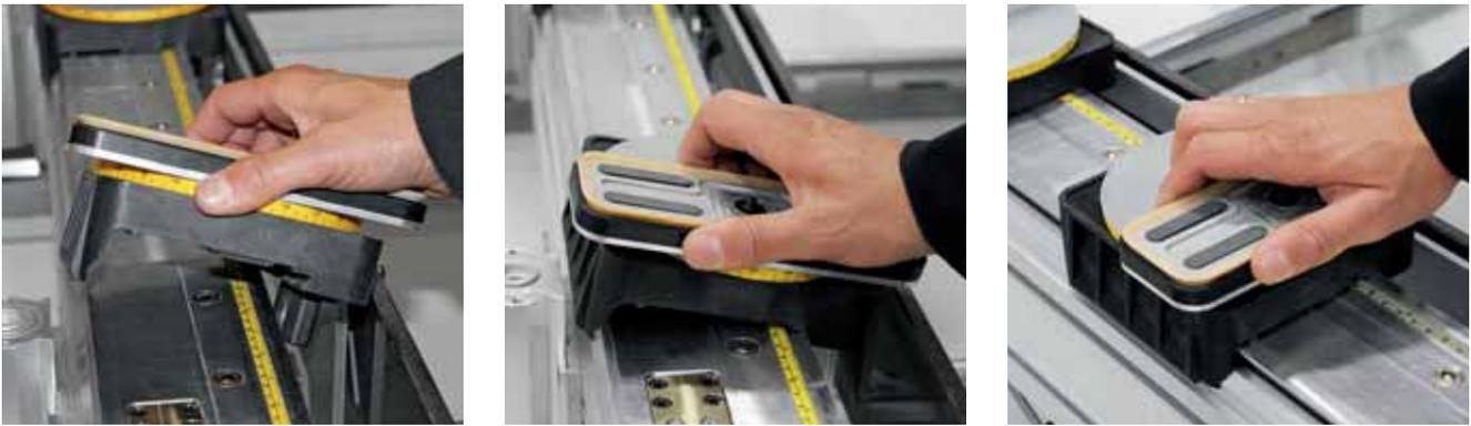
Dank der Schnellankopplung und des schlauchlosen Systems zur Vakuumübertragung kann der Arbeitstisch, je nach Geometrie des zu bearbeitenden Werkstücks, frei konfiguriert werden.
