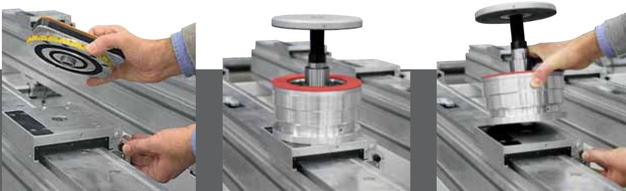
Praktischer und schneller Wechsel per Knopfdruck von Spannzylinder auf Sauger und umgekehrt durch das von SCM entwickelte Schnellspannsystem.
