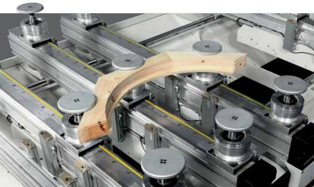
Bezugs- und Aufspannsystem für gekrümmte Werkstücke.
