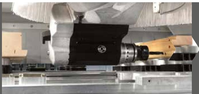
Cero mantenimiento, máxima flexibilidad y óptimo acabado gracias a la tecnología **BEL TECH (Belt Technology System)**, el sistema con reenvío de correa que anula la transmisión de vibraciones y calor desde la herramienta al motor. Gracias a su geometría exclusiva de fabricación, el grupo Prisma permite trabajar con eje horizontal en espacios reducidos.
