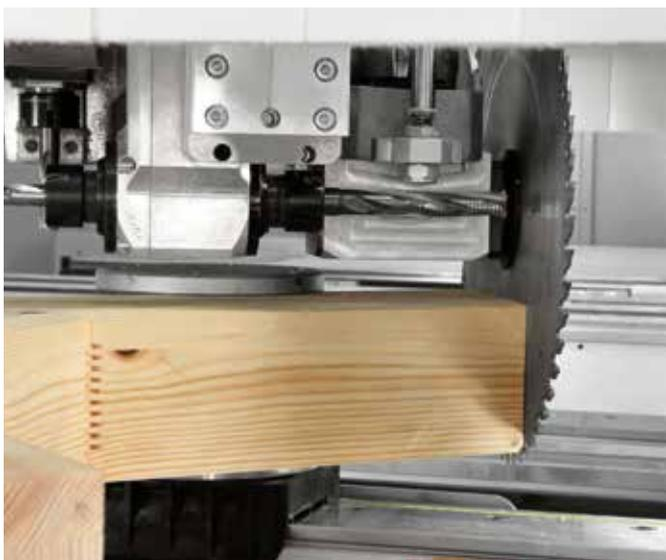
La hoja de 300 mm de diámetro orientable a 360° permite realizar cortes recto o inclinados en elementos de gran espesor.
