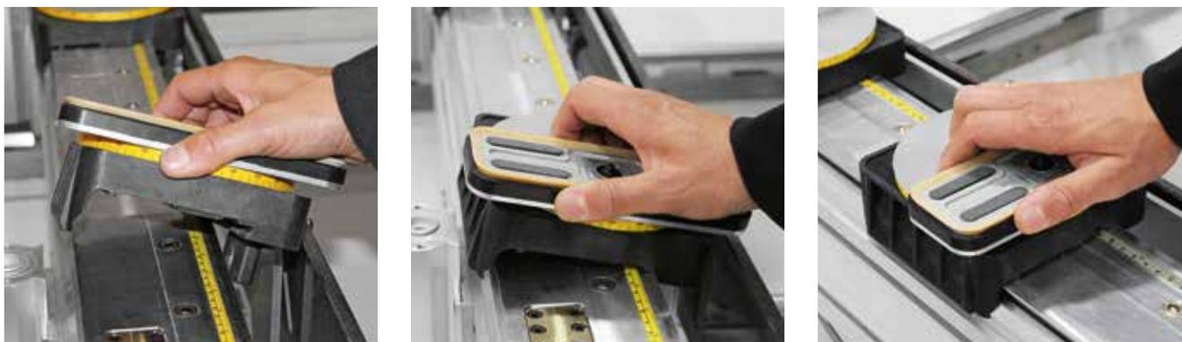
Gracias al enganche rápido y al sistema de transmisión del vacío “tubeless”, es posible configurar libremente la mesa de trabajo en función de las geometrías de las piezas que se han de trabajar.
