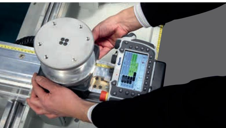
Sur la version "Pilot", le positionnement est guidé par le logiciel dédié pour l'usinage des pièces. Des capteurs magnétiques relèvent la position exacte de tous les composants en annulant ainsi les risques de collision.
