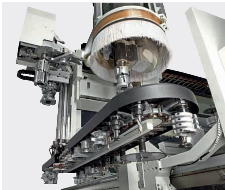
Machine toujours équipée pour faire front à n'importe quel usinage grâce au magasin à chaîne TRC et ses 48 postes disponibles pour des outils de grandes dimensions et à double profil.
