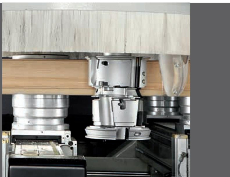
Prisma permet d'usiner jusqu'à 10 degrés sous l'axe horizontal.
