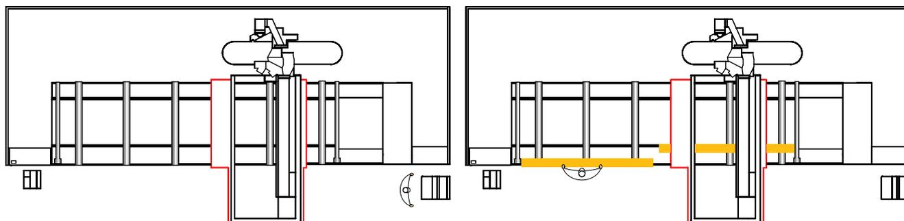
Dispositif de sécurité “Pro Space”: La zone de chargement est complètement dégagée pour réduire au minimum la place occupée en profondeur. Les capteurs installés sur le portique mobile n'arrête la machine qu'en cas de contact. Il permet d'utiliser la machine à la vitesse d'avancement de 25 m/min.
