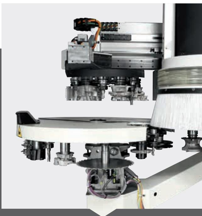
L'Accord FX dispose de solutions adaptables à n'importe quelle production, comme le Rapid 12 embarqué, permettant notamment le changement d'outil en temps masqué et compatible avec d'autres magasins comme le Rapid 16 ou 24.
