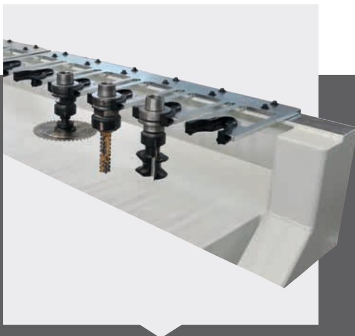
Per avere il massimo degli utensili a disposizione il magazzino a rastrelliera può contenere fino a 12 postazioni utilizzate da tutte le teste presenti sul gruppo operatore.
