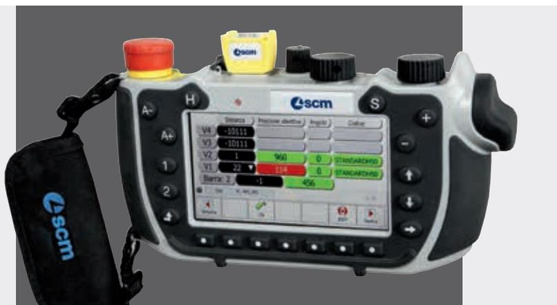
Operazioni veloci che non richiedono ulteriori controlli; sul display della console mobile viene visualizzata la quota di posizionamento di ogni singolo elemento ed evidenziati in tempo reale tutti i movimenti fino al raggiungimento della giusta posizione.
