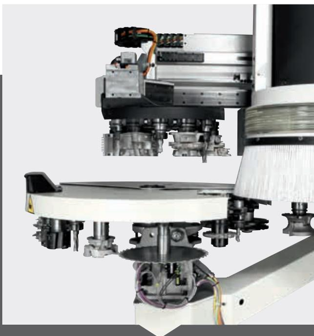
Accord fx dispone di soluzioni che si adattano a qualsiasi produzione come il rapid 12 on-board che permette anche il cambio utensile in tempo mascherato abbinabile a ulteriori magazzini supplementari come il rapid 16 o 24.
