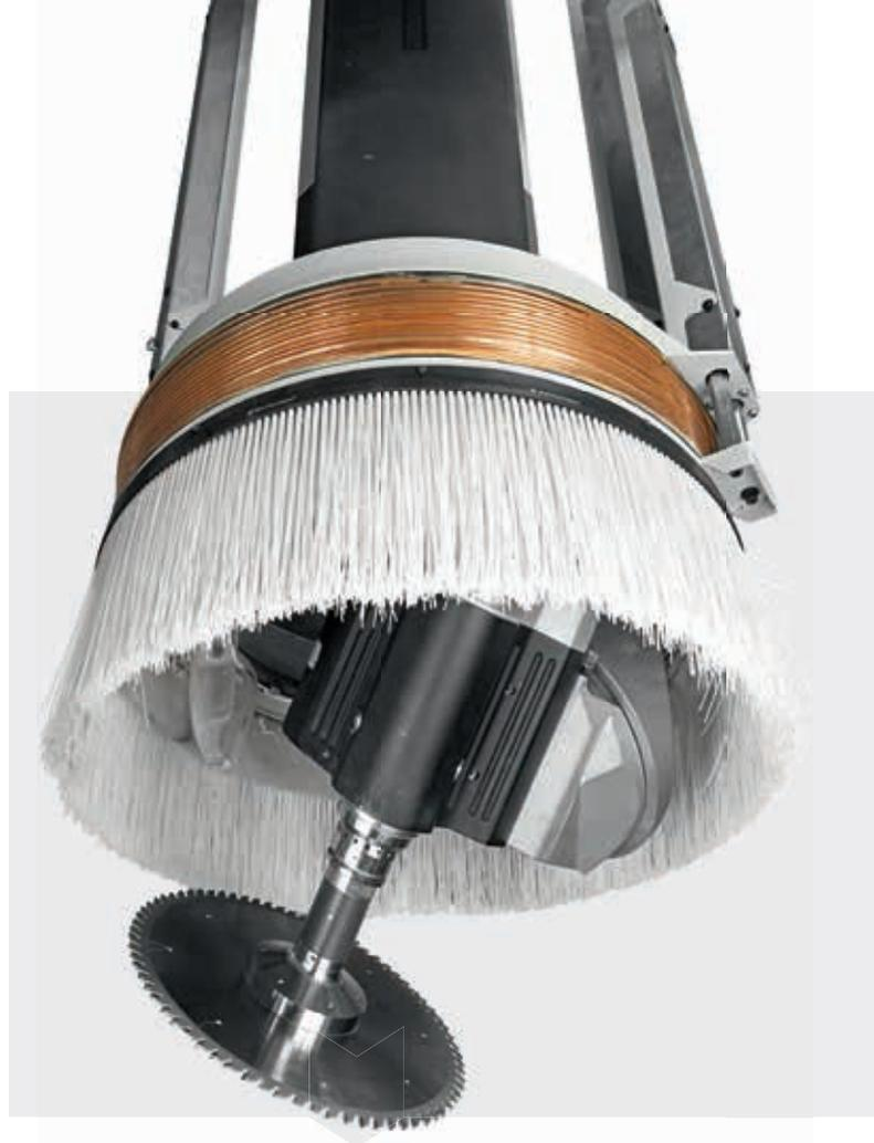
Gli elettromandri di SCM, anche con attacco HSK 63 E, sono potenti ed affidabili. Permettono l'utilizzo di utensili di grandi dimensioni e con doppio profilo garantendo facilità di profilatura su elementi di grossa sezione.
