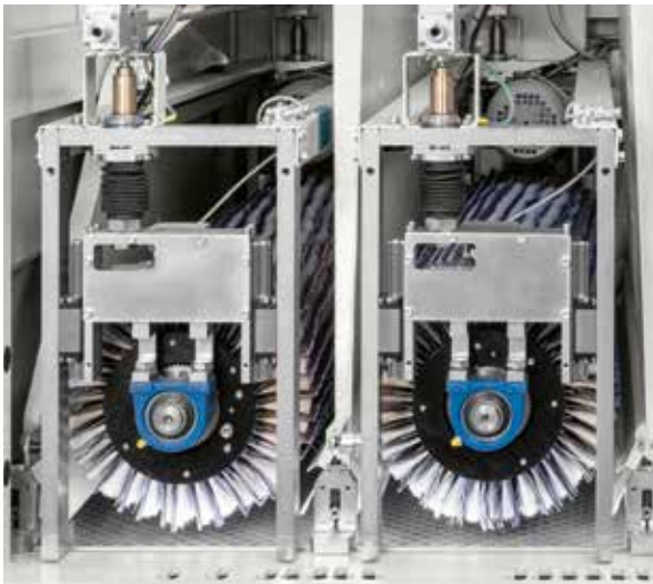
Oszillierende Bürstenaggregat mit doppelter Drehrichtung für doppelseitige Schleifmittel, erhältlich mit Simoni und Flextrim Schleifmitteln.
