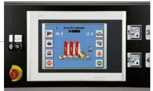
Pro-Sand-Steuerung für die Verwaltung der automatischen Gruppenpositionierung per Touchscreen.
