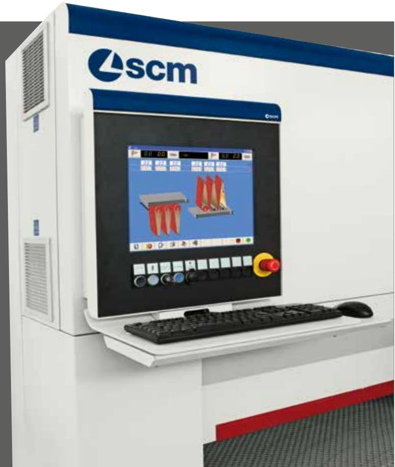
Serienmäßig in alle DMC System Schleifmaschinen eingebaut, ermöglicht es die Steuerung "Pro-Sand", alle Arbeitsparameter am Touchscreen einzustellen und in Echtzeit zu prüfen, ob die Maschine richtig arbeitet.
