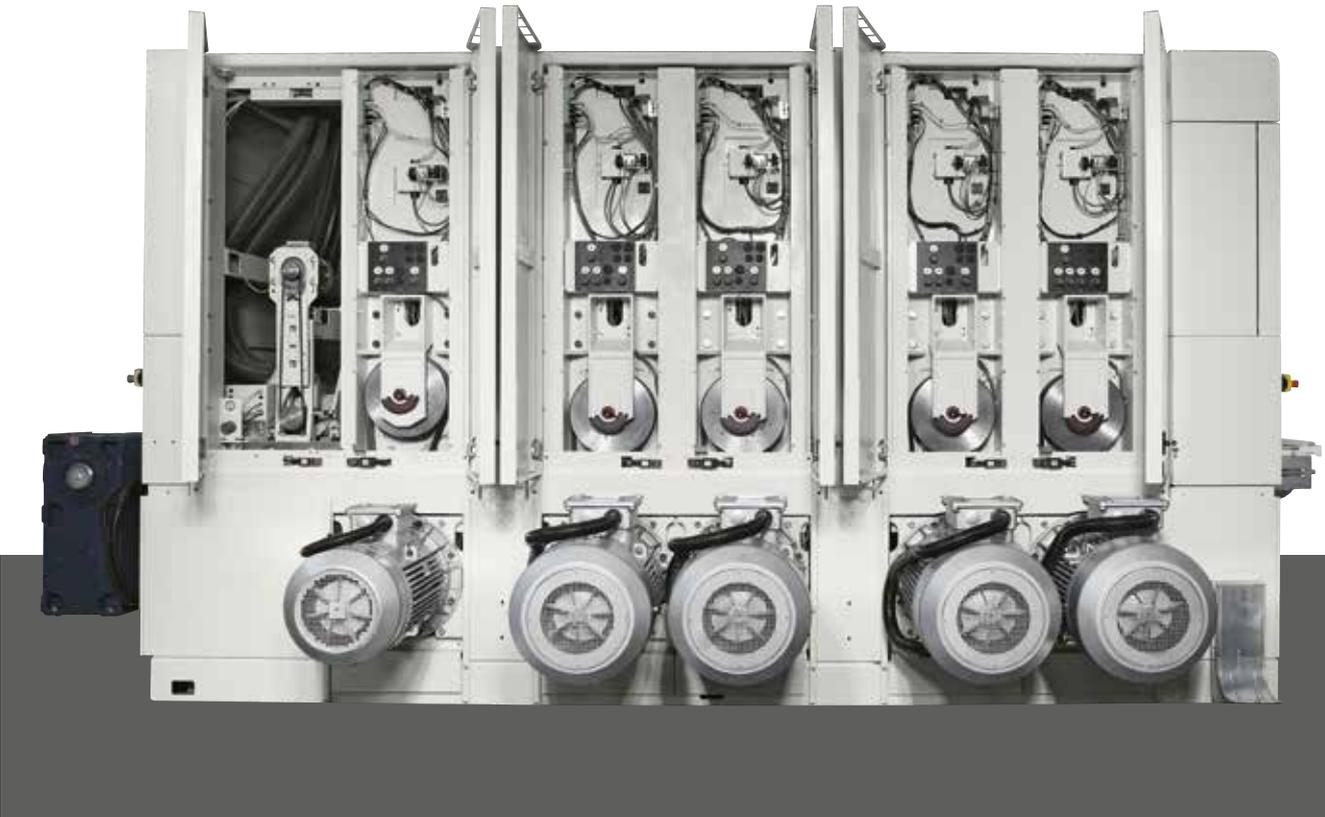
Die Hochleistungsmotoren (bis zu 90 kW) und die große Auswahl an Arbeitsaggregaten ermöglichen es, auch bei höheren Produktionsgeschwindigkeiten von 60 m/min verschiedenste Finish-Effekte zu erzielen.
