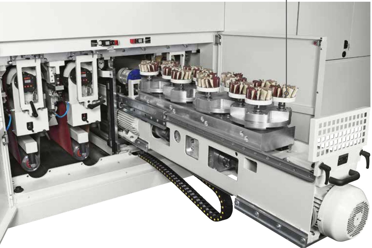
Extrem homogene und hochwertige Oberflächenbearbeitung durch das **Arbeitsaggregat „Planetario“**, das keine Spuren der Schleifrichtung hinterlässt, da die Bearbeitung gleichzeitig in mehreren Richtungen erfolgt.
