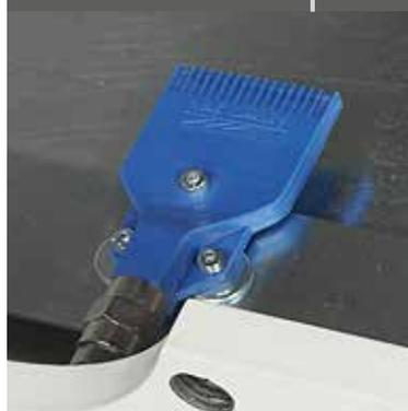
Die unteren Aggregatmodule sind mit Druckluft-Reinigungsdüsen ausgestattet, die es ermöglichen, Staubrückstände, die sich während der Bearbeitungen ansammeln, vom Maschinenboden zu entfernen.
