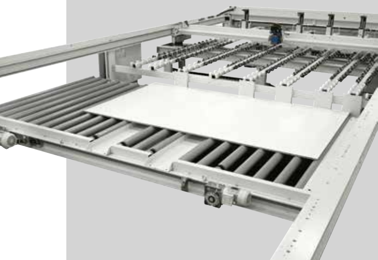
Alineadores frontales para la carga automática.
