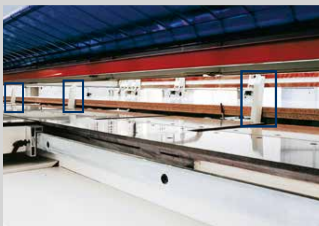
Alineadores frontales para la carga automática.
