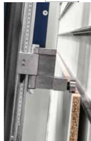
Dispositivo para la ejecución de cortes repetitivos en horizontal (opc. v, vs, vsi)
