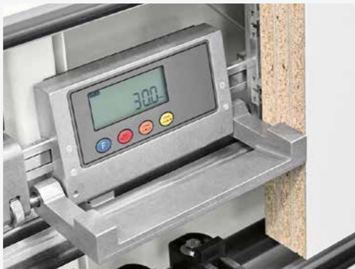
Lector digital de las cuotas verticales
