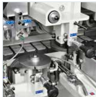
RAS-M Ziehklingenaggregat: perfekte Endbearbeitung von Radiuskanten aus PVC/ABS.
