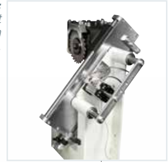
K-1 Kappaggregat: doppeltes Sägeblatt mit unabhängigen Tastrollen.
