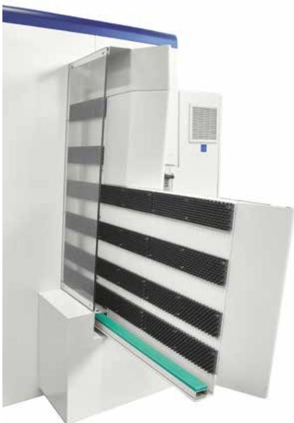
**Ergonomisch**, die Seitenstützen ermöglichen dem Bediener Platten die ergonomische Aufgabe und Entnahme von Platten bis zu einer Länge von 3050 mm.
