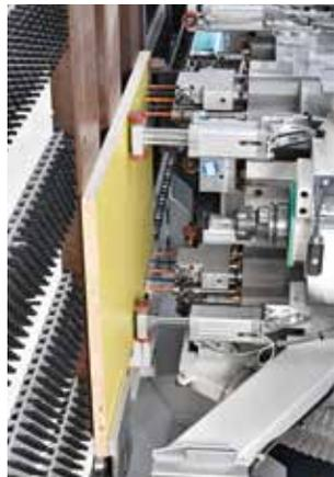
**Unvergleichbare Bohrqualität** dank der stufenlos einstellbaren Drehzahl von bis zu 8000 Umdrehungen/min und der Verwendung von speziellen Niederhaltern.
