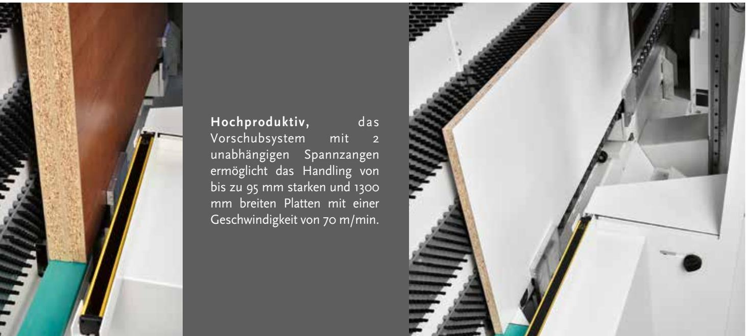
**Hochproduktiv**, das Vorschubsystem mit 2 unabhängigen Spannungen ermöglicht das Handling von bis zu 95 mm starken und 1300 mm breiten Platten mit einer Geschwindigkeit von 70 m/min.
