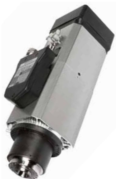
**Leistungsfähig und zuverlässig**, dank der 6,6 kW Leistung der Elektroschleifmaschine mit HSK63-F-Werkzeugaufnahme und Drehzahlen von bis zu 24000 Umdrehungen/min die perfekte Lösung für Fräsbearbeitungen auf den unterschiedlichsten Plattenwerkstoffen. Auf dem oberen Kopf positioniert ermöglicht das Fräsaggregat Blind- und Durchgangsfräsungen.
