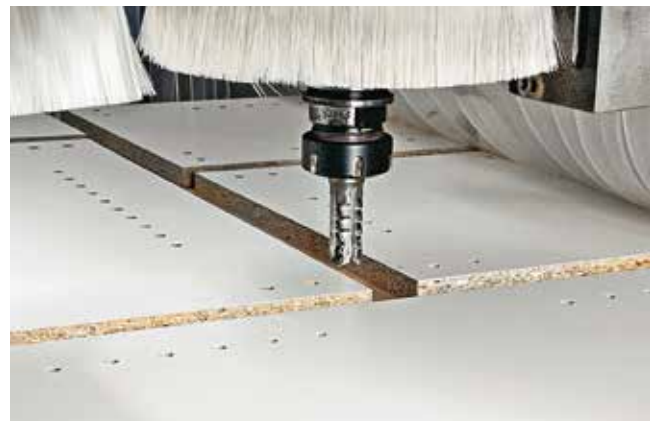
Bearbeitung von kleinen Werkstücken dank der mechanischen coaxialen Andruckvorrichtung.
