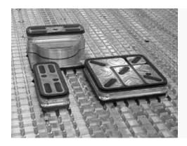
Amplia gama de ventosas MPS y MODULSET para sujetar las piezas sobre la mesa de trabajo según los trabajos para efectuar.
