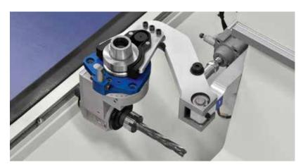
Almacén "**Pick-up**" a 1 posición con posicionamento neumático fijado al travesaño móvil. Equipamento ideal para utilizar cabezales a renvio angular de gran tamaño.
